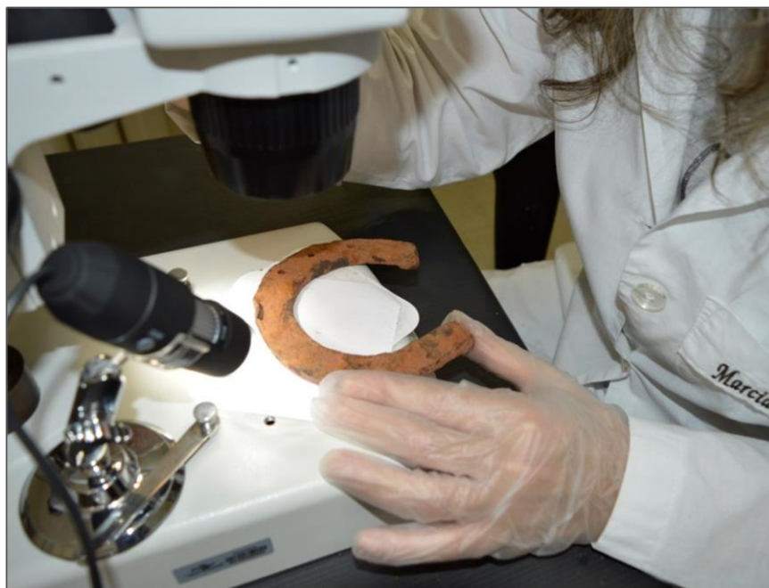
Figura 29 - Análise com lupa estereoscópica e microscópio USB
