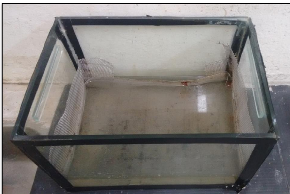
Figura 25 - Tela de aço macio formando o ânodo final Foto: Autor
