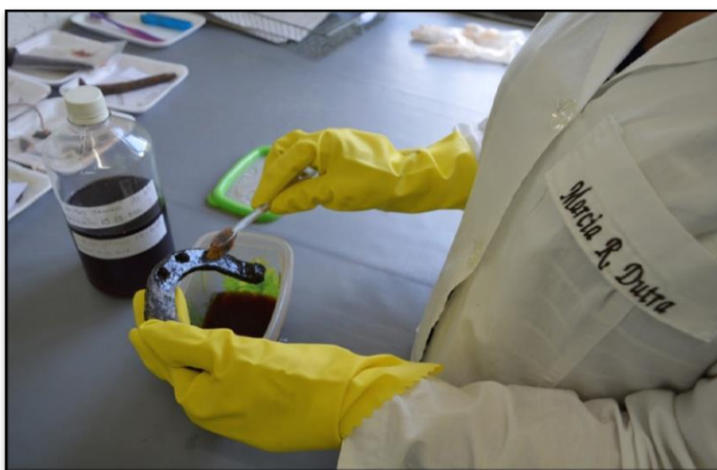
Figura 38 - Aplicação de inibidor de corrosão – ácido tânico Foto: Autor
