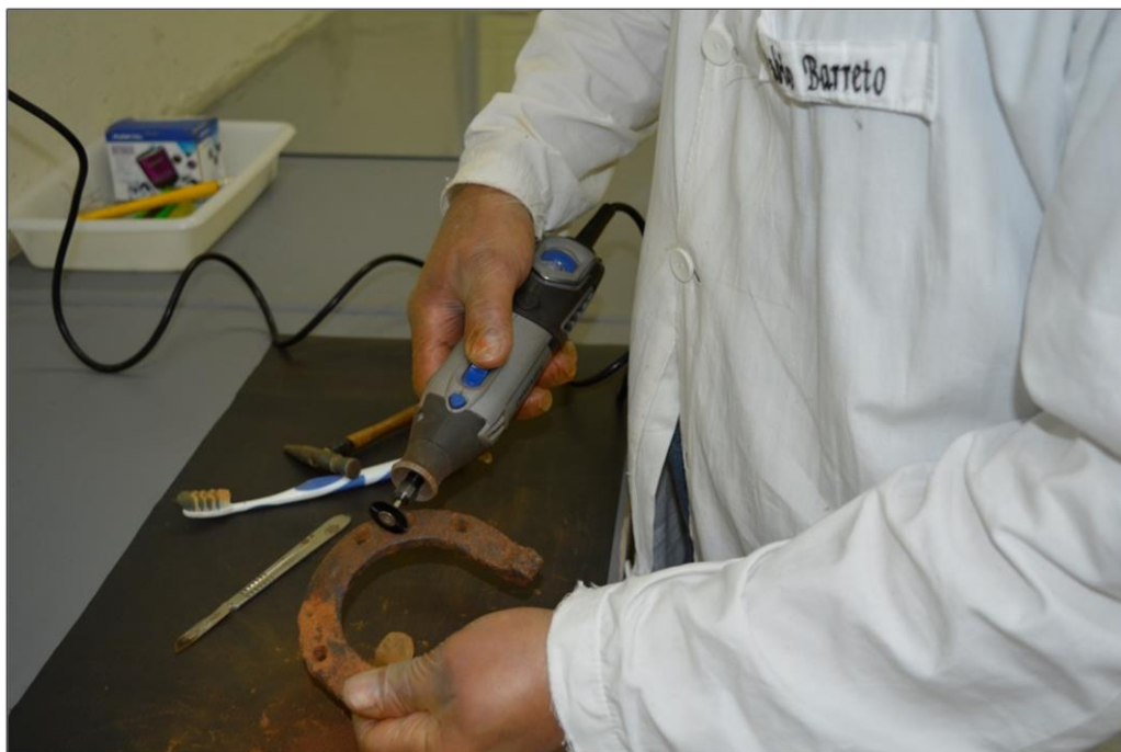
Figura 35 - Limpeza mecânica com micro retífica Foto: Márcia Ribeiro – Conservadora
