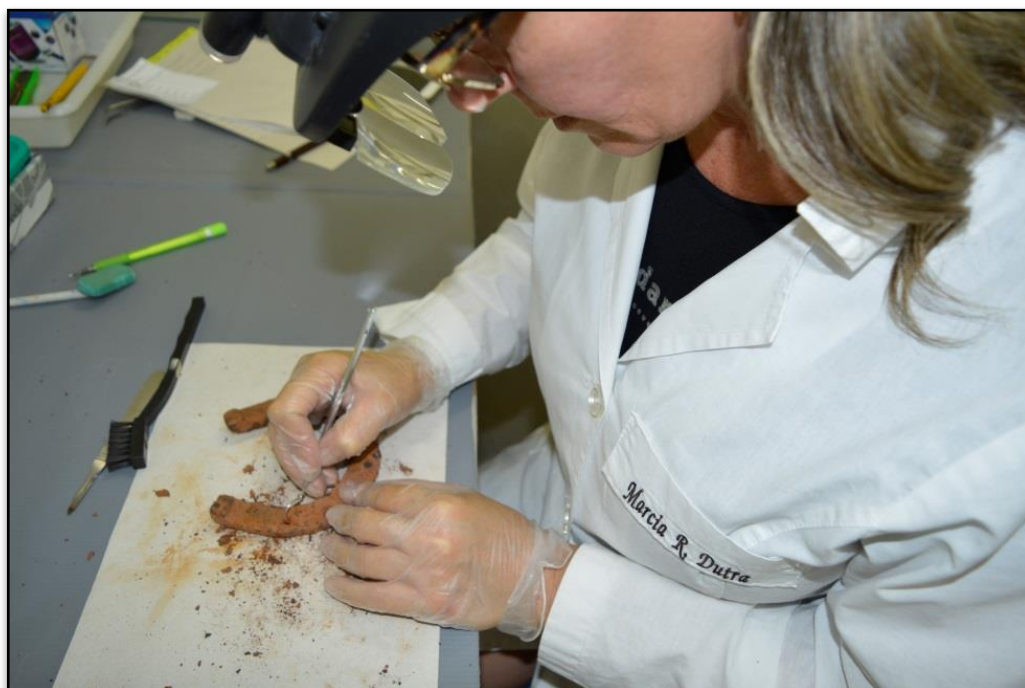
Figura 34 - Limpeza manual com uso da sonda exploradora Fonte: Autor
