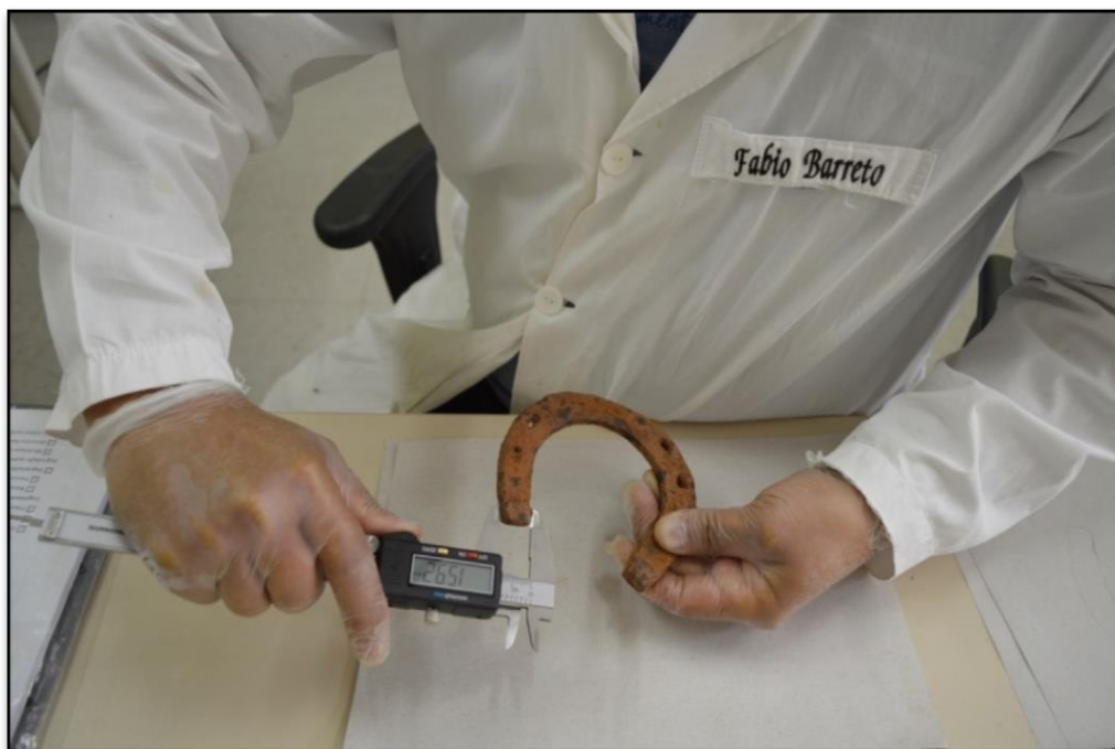
Figura 31 - Registro das medidas iniciais com paquímetro eletrônico Fonte: Autor
