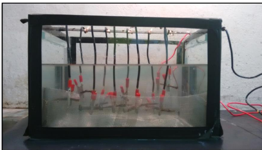
Figura 43- Tratamento redução eletrolítica de 10 cravos metálicos Foto: Autor
