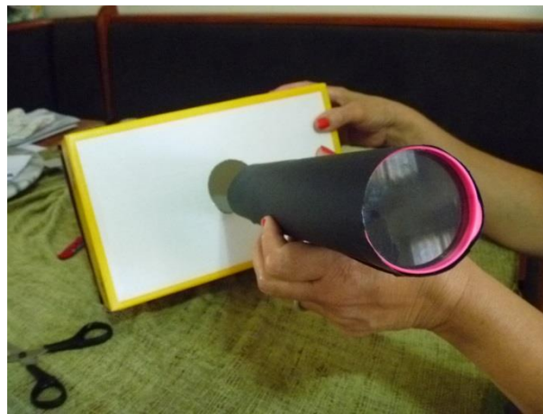
Figura 26 – Encaixe da lente na câmera
