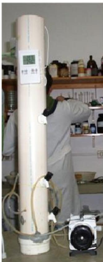
Figura 4 - Biorreator de mistura completa.
