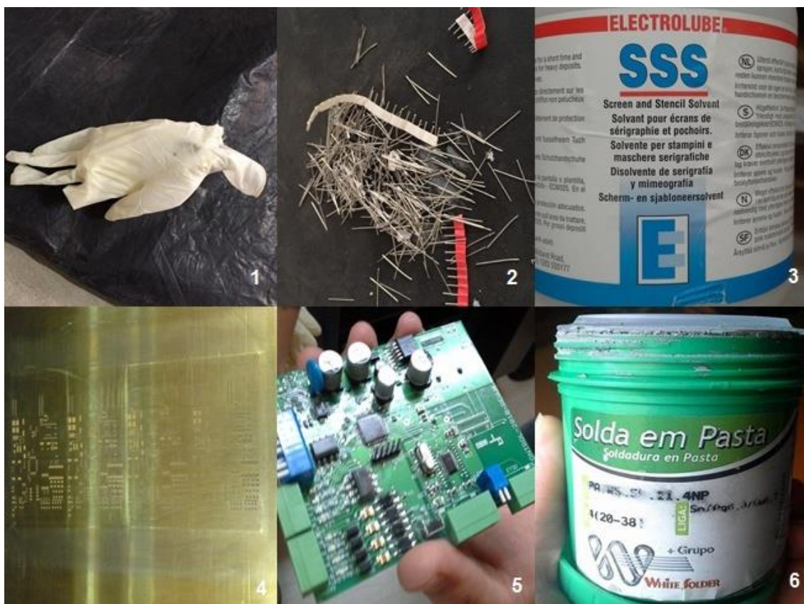
Figura 11 - Resíduos gerados no setor de eletrônica. 1- Luvas contaminadas; 2- material metálico; 3- Produto de limpeza de equipamentos; 4- Gabarito; 5- Placa de circuito impresso em fase de montagem; 6- Resíduo de pasta de solda com prazo de validade expirado.
