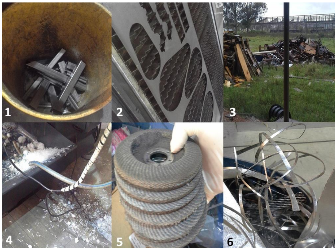
Figura 8 – Resíduos gerados no setor de mecânica. 1. resíduo de metalon; 2. resíduo de chapas de aço; 3. acúmulo de sucatas no exterior da fábrica; 4. limalha de tecnil; 5. discos de lixamento; 6. rebarbas de alumínio.
