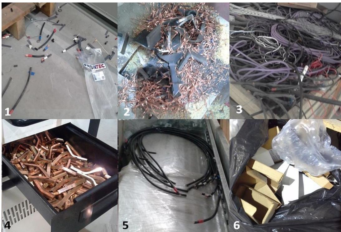
Figura 9 - Resíduos gerados no setor de elétrica. 1. resíduos de cabos de alimentação; 2. limalha de cobre e barramento de plástico; 3. armazenamento de cabos de alimentação; 4. resíduos de barra de cobre; 5. resíduos de cabo de alimentação; 6. resíduos de embalagens de papel, papelão e plástico.
