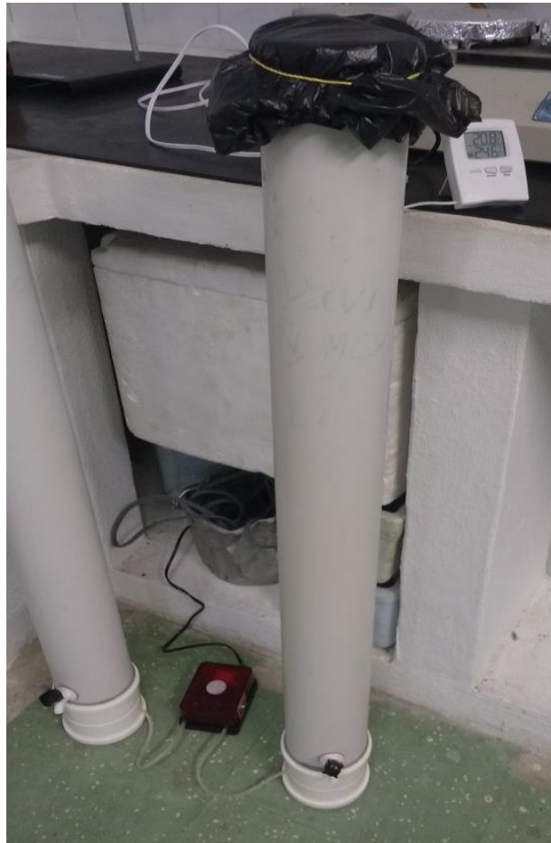
Figura 3 - Biorreatores de mistura completa.
