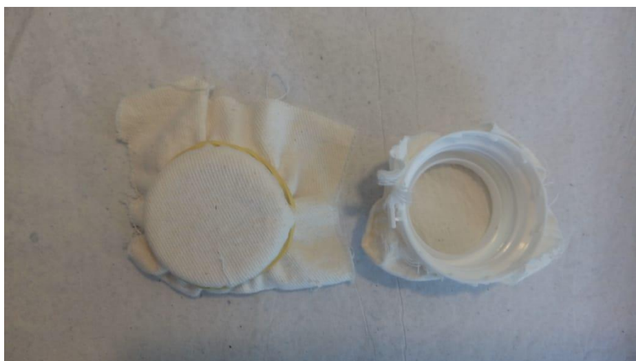
Figura 5 – Tampas com os filtros fixados com auxílio de elásticos, vista superior e inferior.
