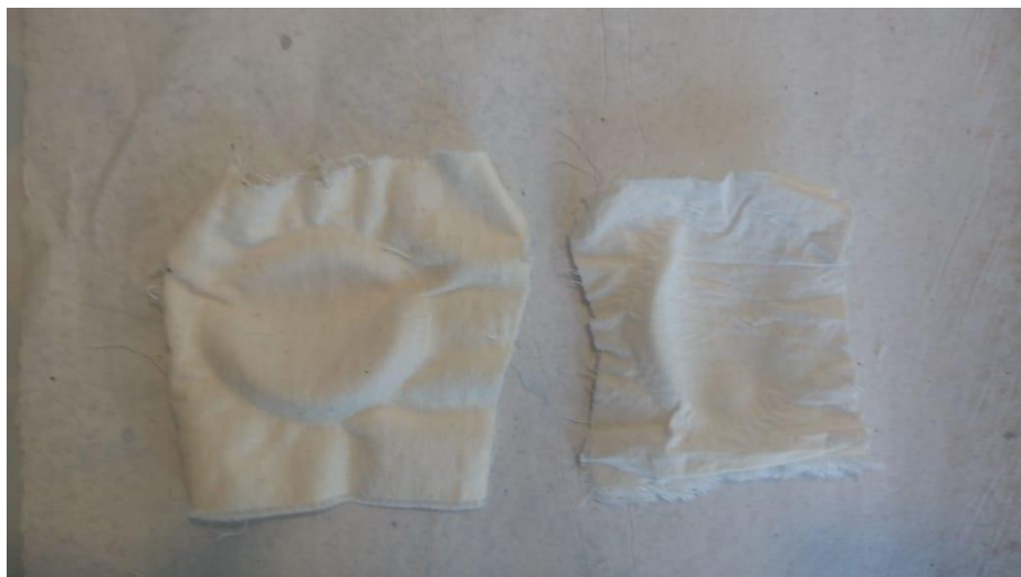
Figura 4 – Filtros de algodão, recortados com 8cm de lado, à esquerda filtro FF e à direita filtro FA.
