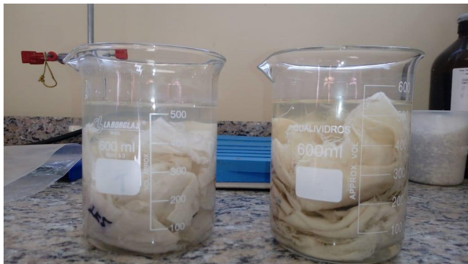
Figura 12 – Filtros imersos em água destilada para remoção das partículas retidas, a esquerda os filtros FA e a direita os filtros FB.
