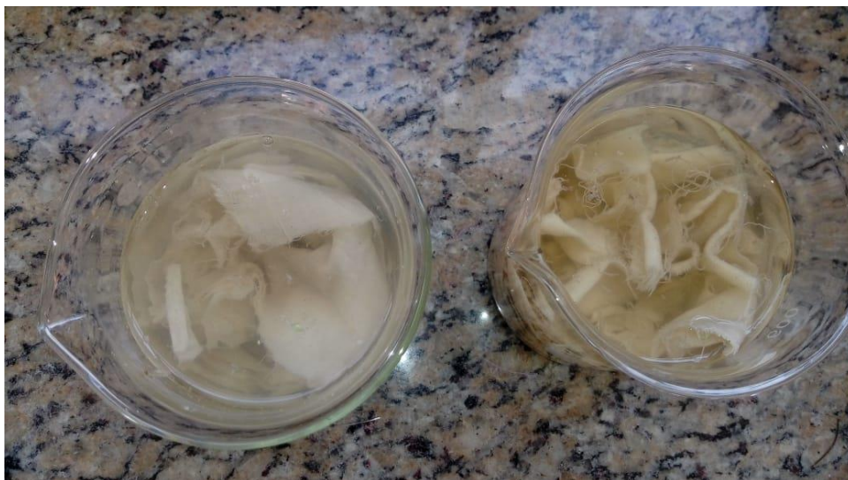
Figura 13 – Vista superior dos filtros imersos em água destilada para remoção das partículas retidas, a esquerda os filtros FA e a direita os filtros FB.
