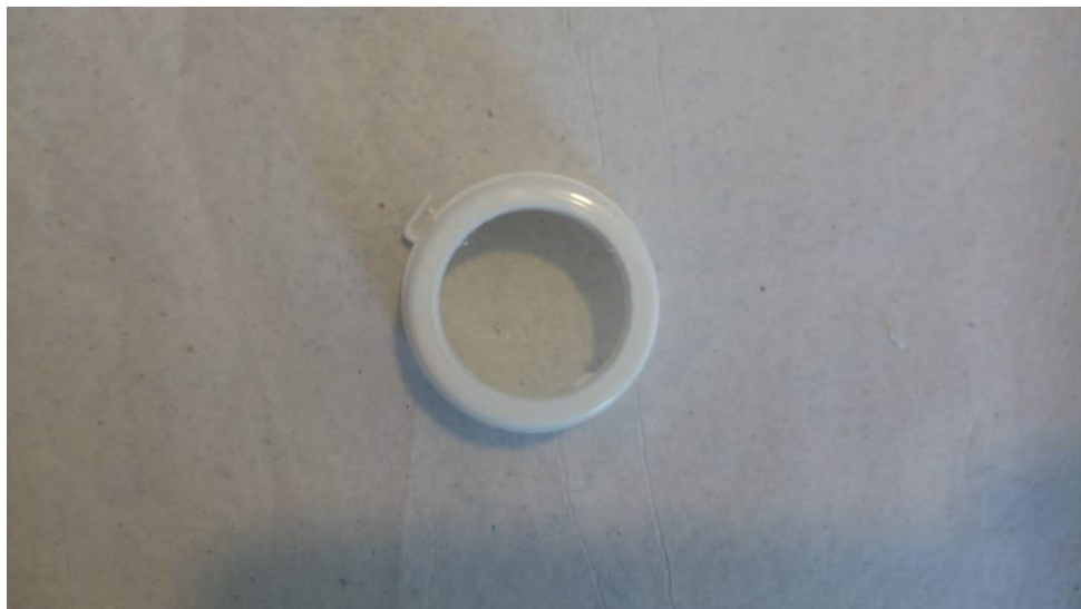
Figura 3 – Tapa adaptada para fixação dos filtros.
