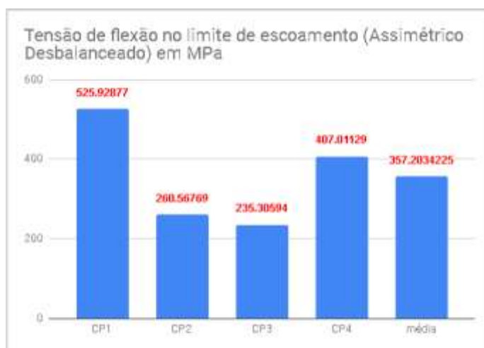
Figura 20: Tensão de flexão no limite de escoamento dos corpos de prova assimétricos. Fonte: Autoria Própria
