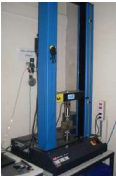
Figura 14: Equipamento universal de ensaios EMIC23/5D da UFRGS. Fonte: (CALEGARI, 2018).
