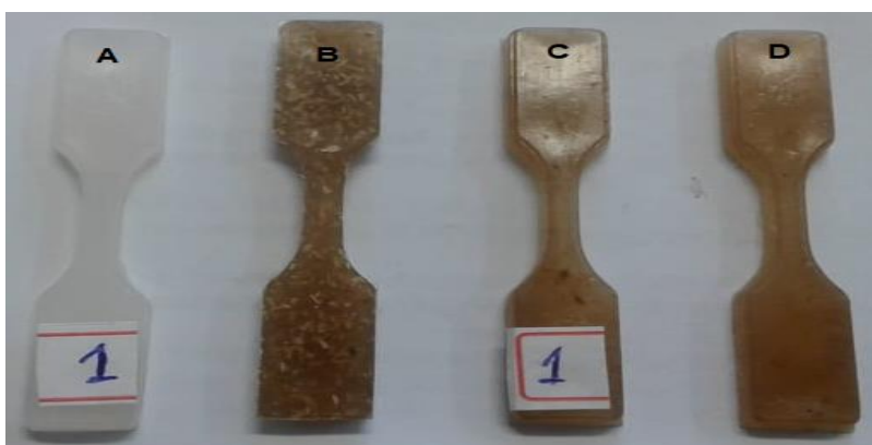
Figura 10 - Corpos de prova: A) Polipropileno, B) Polipropileno + casca do arroz, C) Polipropileno + celulose, D) Polipropileno + celulose modificada.
