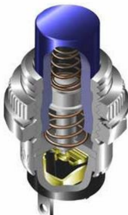
Figura 8: Corte transversal de um modelo de push button.
