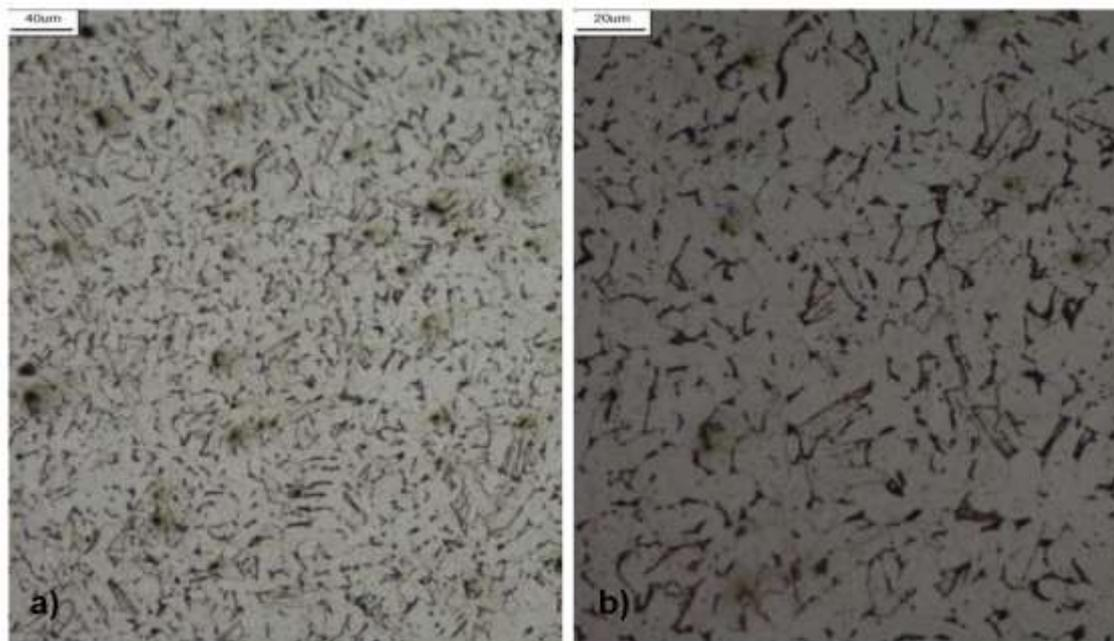
Figura 12 - Micrografia da seção superficial do aço carbono 1020. a) Ampliação de 100X e b) ampliação de 200X. Ataque: Nital 3% - 35 s
