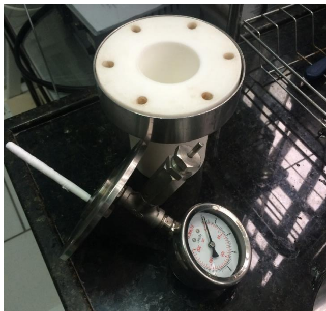
Figura 3 – Célula reacional do forno de micro-ondas, ainda aberta.
