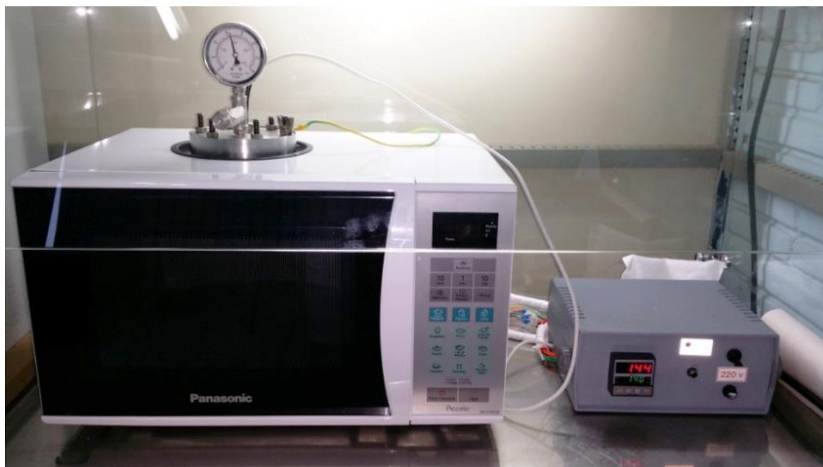
Figura 1 – Forno de micro-ondas adaptado para síntese pelo método HAM. Fonte: Laboratório CCAF - UFPEL
