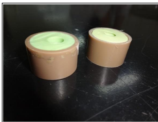
Figura 8 - Molde padrão feito de cano de PVC e silicone.
