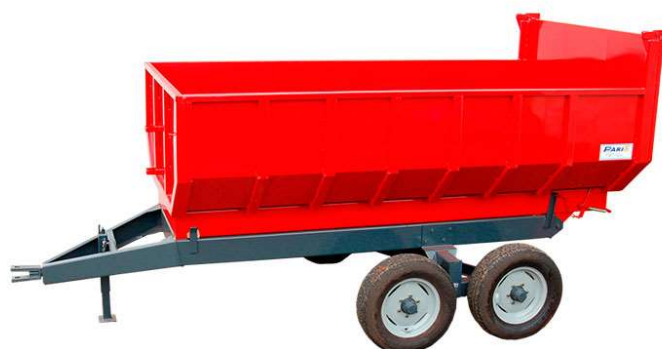
Figura 7: Carreta basculante para transporte de produtos agrícolas, a qual faz uso do macaco estudado (Paris Implementos Agrícolas, 2017)
