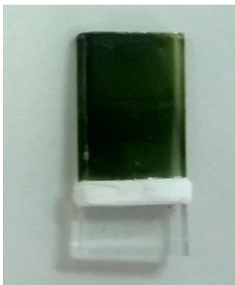
Figura 3.1 - Gel de V_2O_5 depositado sobre substrato de FTO.
