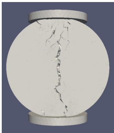
Figura 4 - Exemplo de como foi posicionada a pastilha e modelo de fratura do ensaio.
