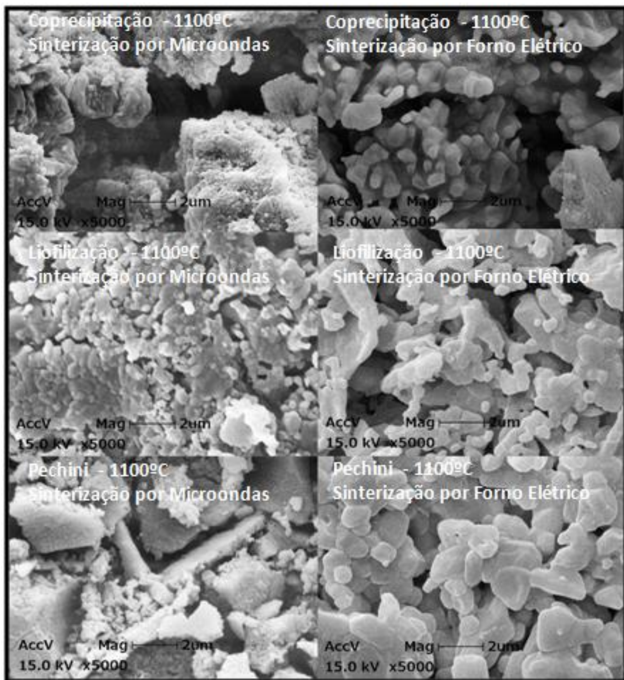
Figura 7 - Microscopia eletrônica de varredura das pastilhas obtidas por sinterização pelos métodos de Coprecipitação, Liofilização e Pechini (Microondas e Forno Elétrico) à 1100° graus Celcius.
