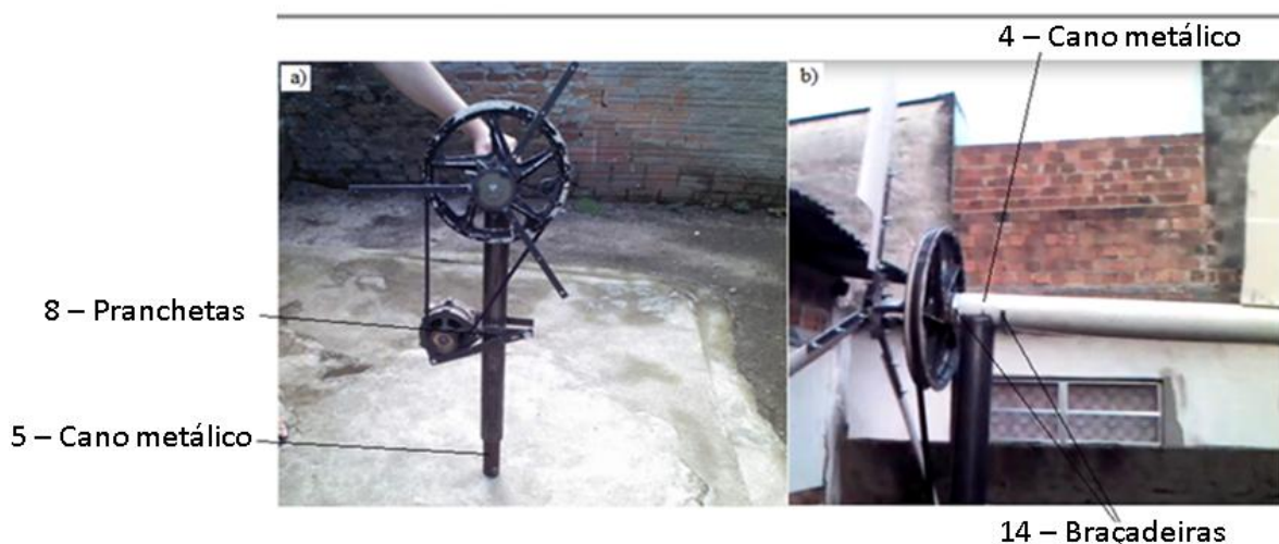
Figura 19. Imagem 19 a) Usinagem do cano 5 para encaixe no rolamento especial que contém o cano 4 e soldagem da prancheta 8 para atuar como suporte do alternador; 19 b) Soldagem de um pedaço de cano 4 no cano 4, perpendicular, e colocação do leme segurado pelas braçadeiras. Fonte – Pelo autor.
