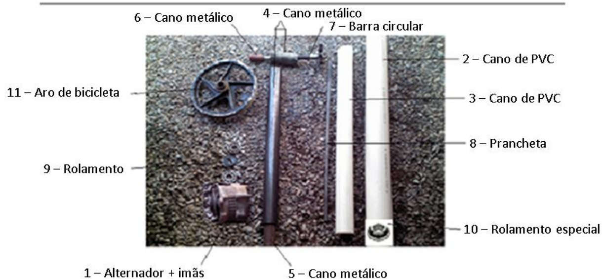
Figura 15. Imagem dos onze principais itens de construção do aerogerador PP constituídos por materiais recicláveis exposto em ordem numérica de acordo com a Tabela 5.
