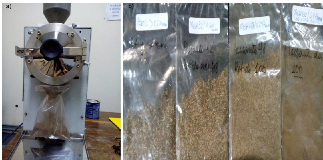
Figura 4.2 - a) moinho de facas, b) fibras após peneiramento em peneiras de mesh 32, 48 e 100.
