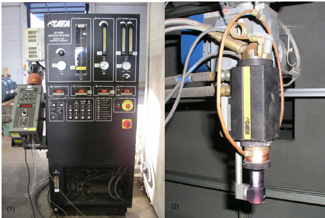
Figura 8 – Equipamentos utilizados para aspersão térmica HVOF: (1) console e alimentador do pó Tafa/Praxair; (2) pistola HVOF Tafa/Praxair.
