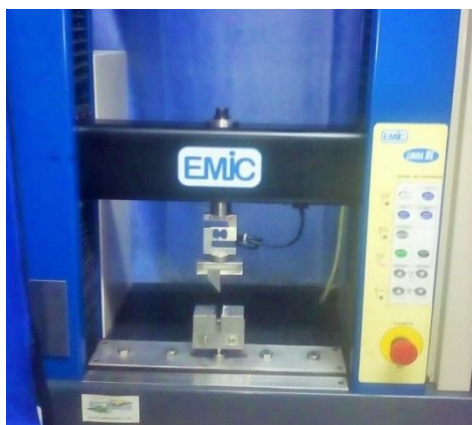
Figura 23 - Máquina utilizada para o ensaio de flexão
