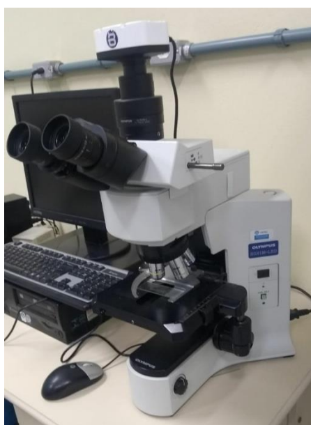
Figura 22 - Microscópio Olympus, modelo BX41M
