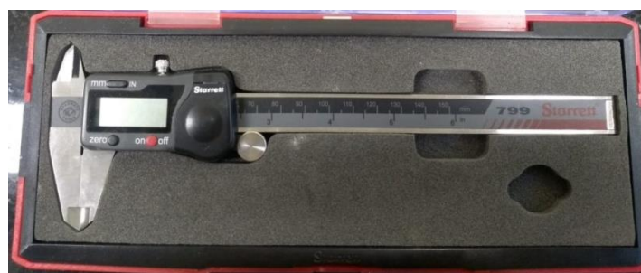
Figura 20 - Paquímetro digital modelo Starrett®, série EC799
