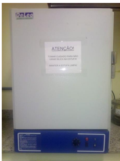
Figura 18 - Estufa sem circulação de ar, marca De Leo
