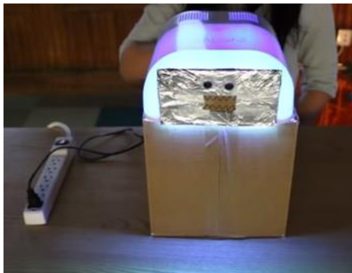
Figura 14 - Equipamento caseiro de pós-cura UV
