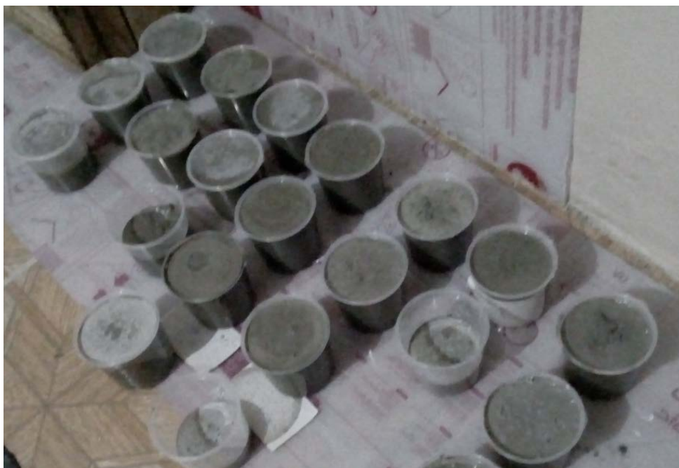
Figura 7 – Recipientes com concreto armazenado e/ou reprocessado.
