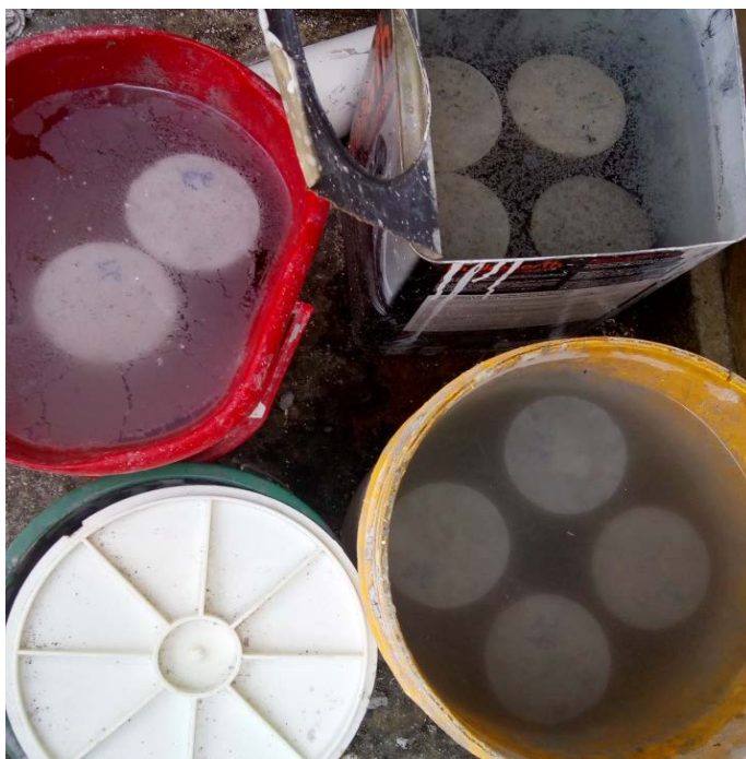
Figura 9 – Cura dos corpos de prova.
