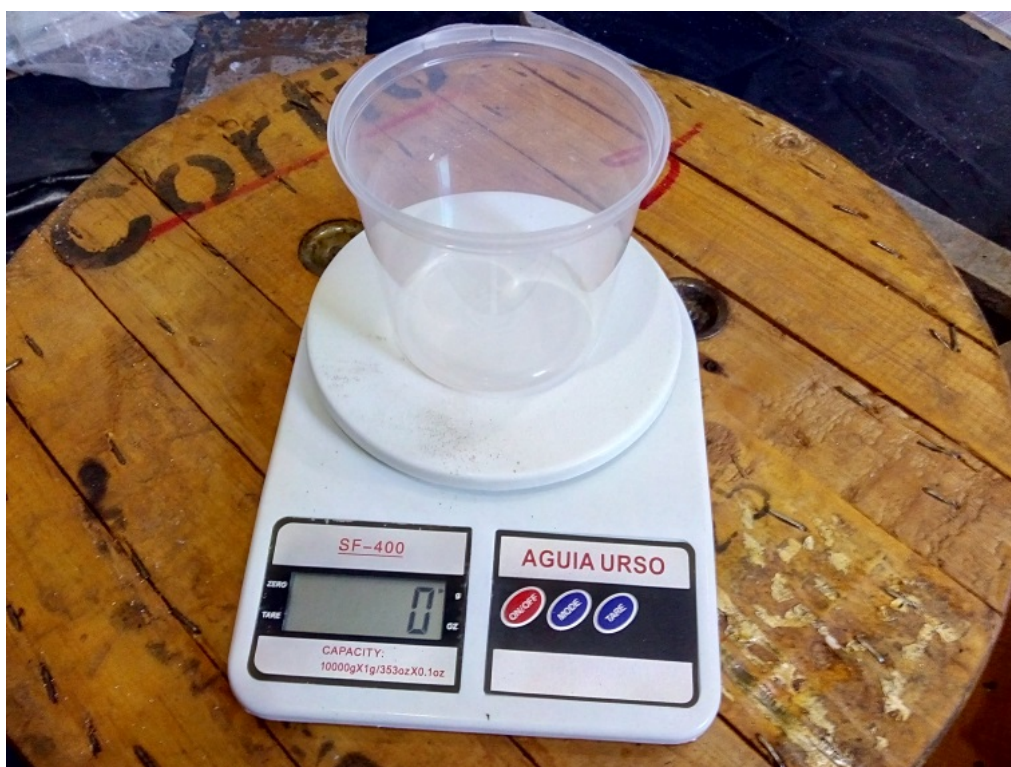
Figura 3 - Balança com precisão de 1g.
