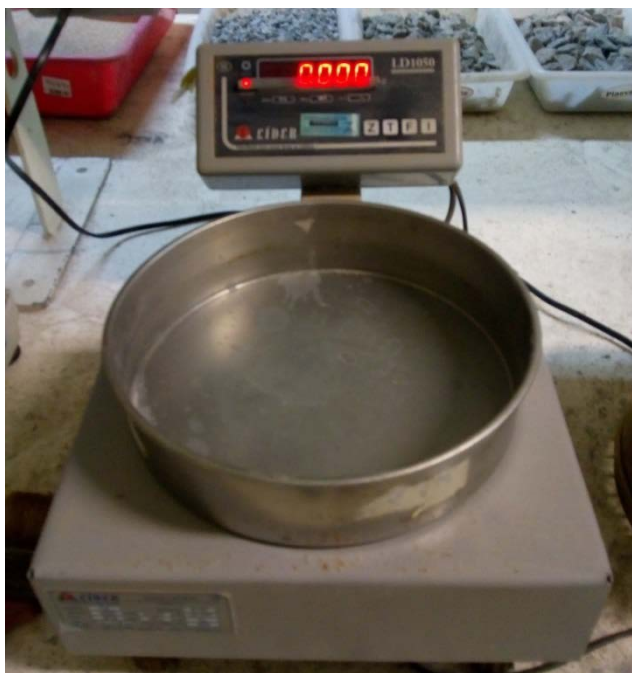
Figura 11 – Balança utilizada na pesagem dos agregados.
