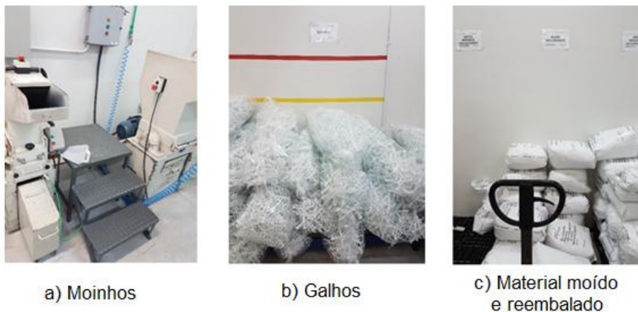
Figura 25 – a) Moinho; b) resíduos; c) material reprocessado.
