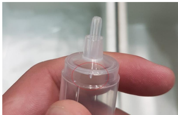
Figura 19 – Presença de trincas em peça moldada por injeção.
