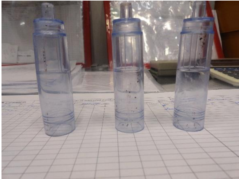
Figura 22 - Defeito de processamento do tipo efeito diesel.
