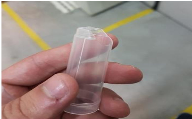
Figura 20 - Defeito de processamento do tipo short shot.
