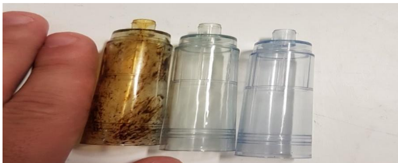
Figura 21 – Defeito do tipo marca de queima em algumas peças moldadas por injeção.
