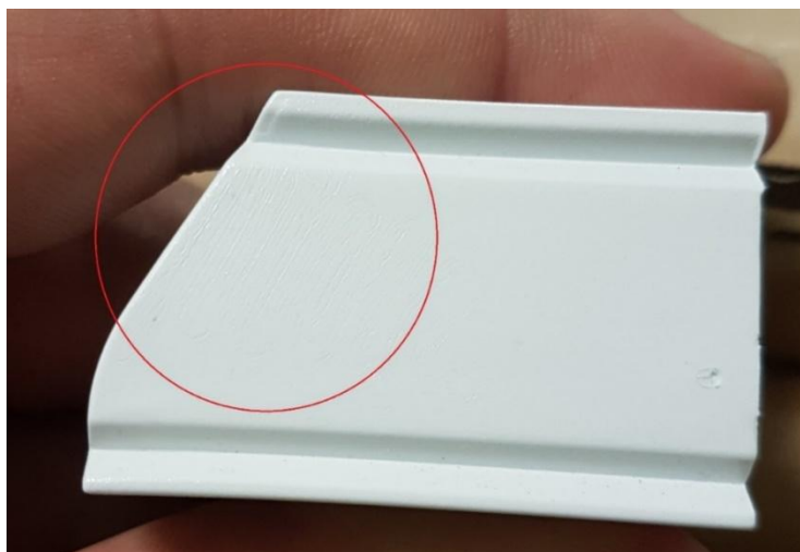
Figura 23 - Defeito de processamento do tipo marcas de fluxo.
