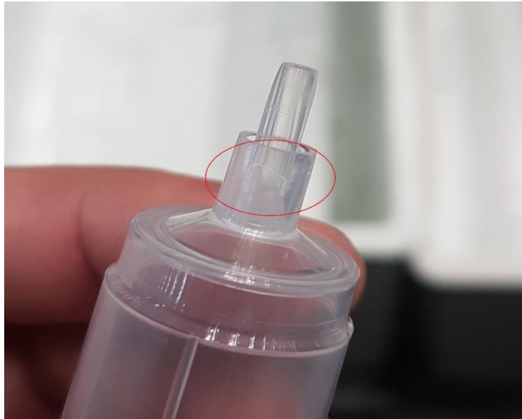
Figura 18 – Presença de bolhas em peça moldada por injeção.
