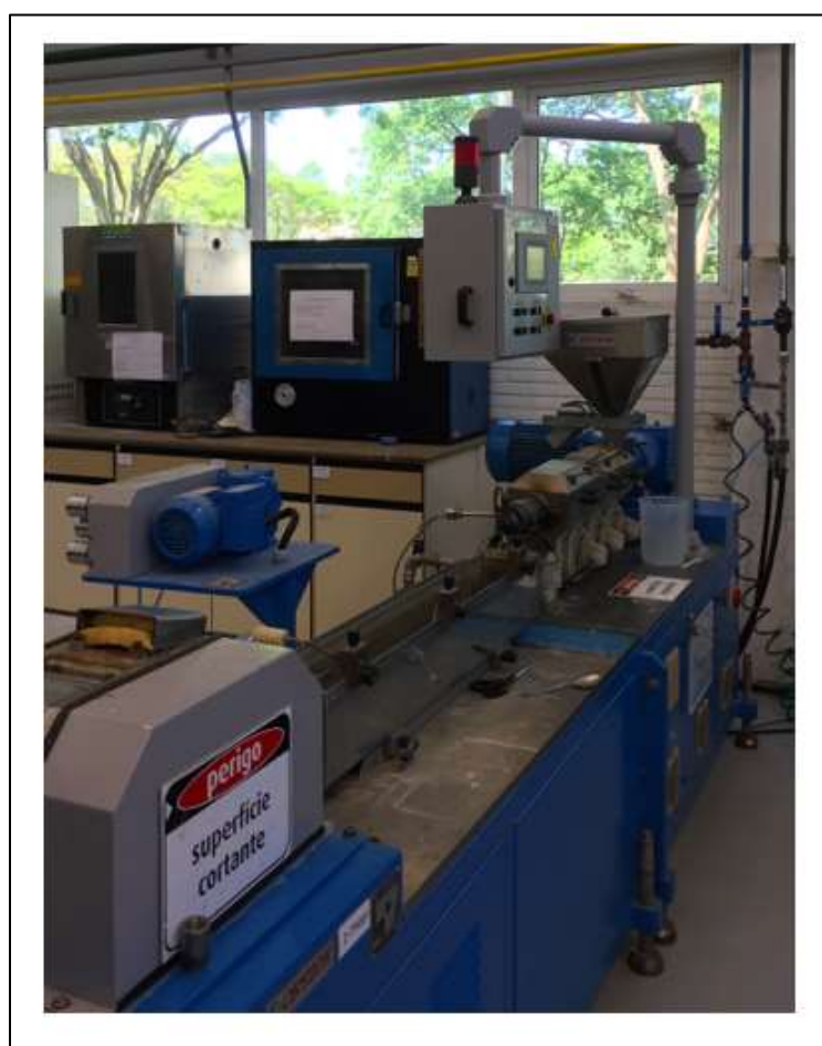
Figura 11 – Extrusora Oryzon (monorosca com 25 mm de diâmetro e L/D = 32).
