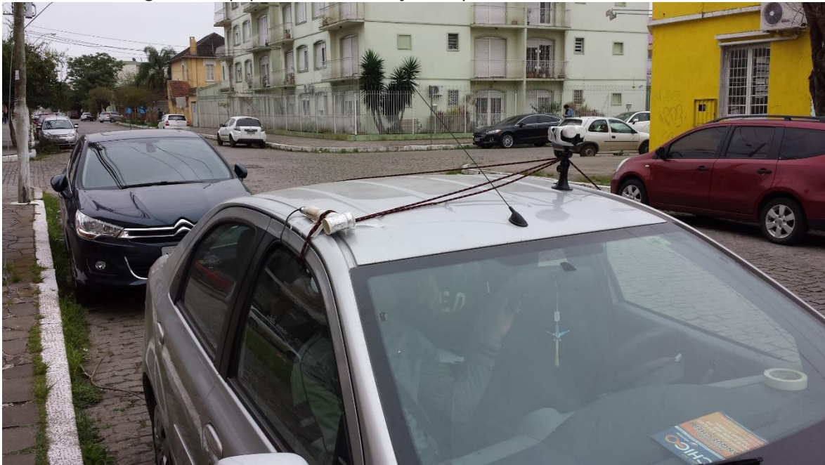
Figura 8 - Equipamento de medição acoplado ao veículo automotor.
