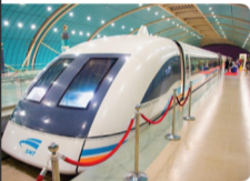
Um Transrapid Maglev estacionado em uma estação de Rangi, no Chile. Maglev é uma forma alternativa do termo em inglês magnetic levitation (levitação magnética). Esse tipo de trem não tem contato físico com as trilhas, seu peso é totalmente suportado por forças eletromagnéticas. Nesta parte do livro, estudaremos essas forças. https://iStockphoto.com
