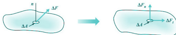
Figura 1.1: Componentes normal e tangencial da força.
