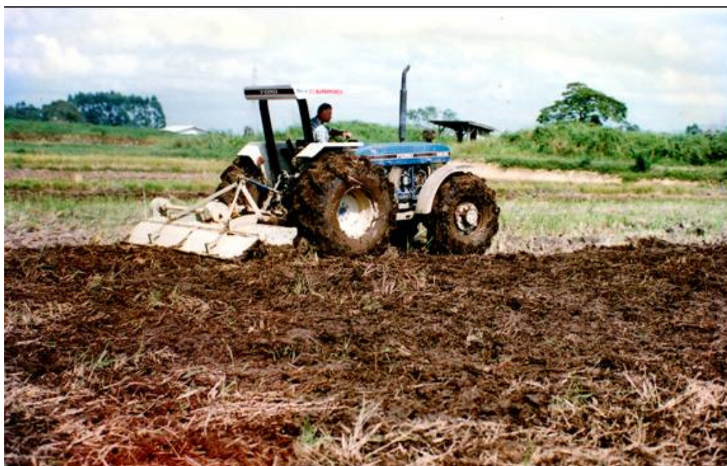
Figura 10: Operação de preparo inicial do solo com uso de enxada rotativa. Foto: Neuza A. Fernandes, 2006.
