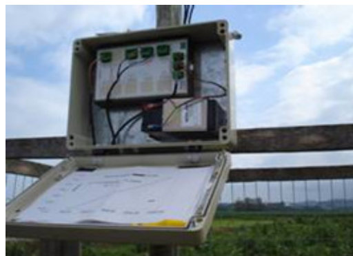
Figura 21: “Logger” ou armazenador de dados, para registrar informações da unidade de Neuza A. Fernandes, anos 2006 e 2008. Foto: Autor.
