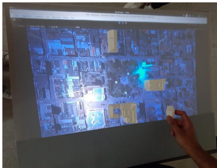
Figura 2. Modelos 3D de prédios históricos do entorno da Praça Coronel Pedro Osório interagindo com a aplicação através da detecção dos fiduciais. Fonte: Autores, 2023.
