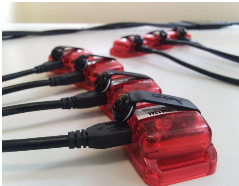
Figura 4. Acelerômetros conectados para download dos dados e carregamento da bateria.
