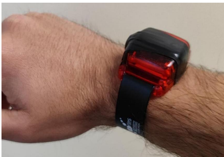
Figura 2. Posicionamento correto do acelerômetro no punho do participante.
