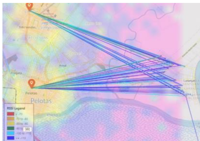
Figura 4. Comunicação entre device LoRaWAN e o gateway público.
