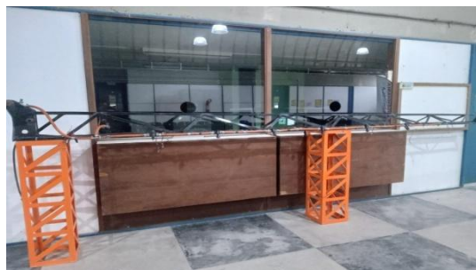
Figura 4: Barra de pulverização com mangueiras e bicos de pulverização instalados.
