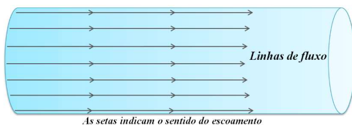
Figura 59 – Linha de fluxo representa a trajetória de uma partícula de fluido ao longo do escoamento.
