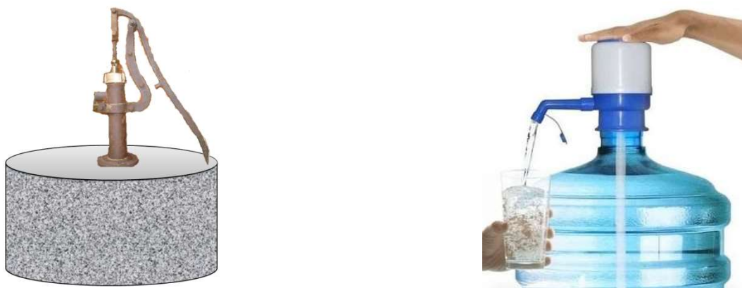
Figura 48 – Na figura à esquerda, temos uma bomba manual antiga para retirada de água de poço artesiano. Na figura à direita, quando você pressiona o dispositivo na parte de cima da bomba d'água é para criar uma região de baixa pressão no interior da mangueira e a pressão atmosférica elevar a água até o seu copo.
