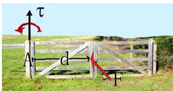
Figura 27 – Para abrir uma cancela, você precisa aplicar uma força, você precisa aplicar um torque \tau_A em relação ao eixo de giro, que é onde fica a dobradiça da cancela (ponto A).
