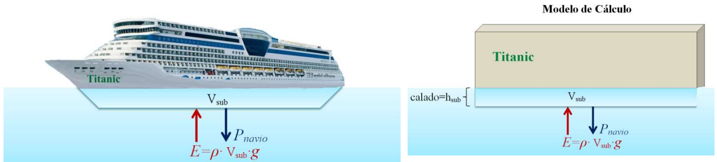
Figura 58 – O navio flutua sobre a água devido o seu peso aparente ser igual a zero. Isso ocorre quando o peso do volume ( V_{\text{sub}} ) de água deslocada coincide com o peso do navio (ou quando a força de empuxo é igual ao peso real do navio, P_{\text{navio}} = m_{\text{navio}} \cdot g ). Na figura à direita, tem-se o modelo de cálculo do navio, juntamente com as forças externas atuantes.
