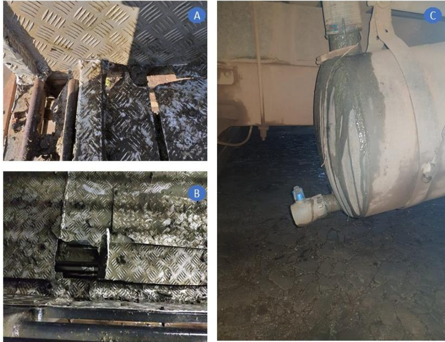
Figura 6. Fotos de buracos, rachaduras e pontas cortantes no piso (A e B) que podem ferir e causar lesões nos animais, assim como interferir na sua condução espontânea e de um tanque de coleta de resíduos com vazamento (C), sendo ineficaz na retenção do conteúdo.
