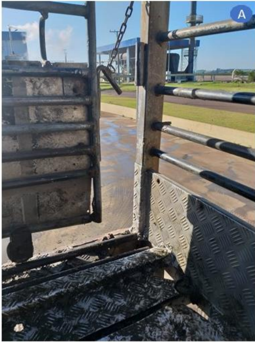
Figura 8. Fotos de um portão de carroceria com anomalia no fechamento (A) e outro portão de carroceria quebrado (B), onde os animais podem colocar partes do corpo causando lesões e ou virem a cair do caminhão.
