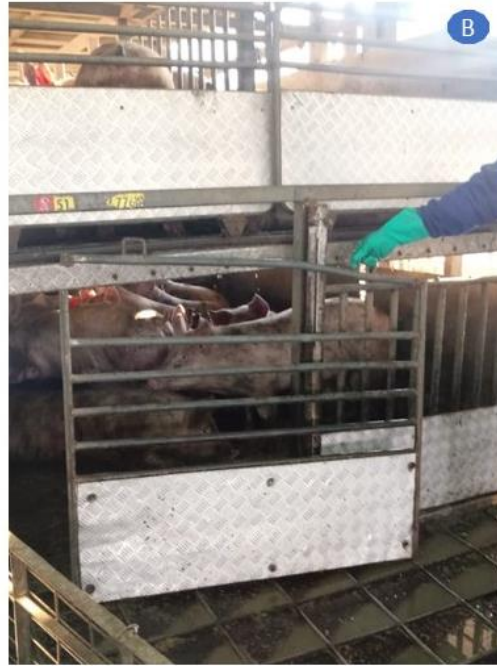
Figura 8. Fotos de um portão de carroceria com anomalia no fechamento (A) e outro portão de carroceria quebrado (B), onde os animais podem colocar partes do corpo causando lesões e ou virem a cair do caminhão.
