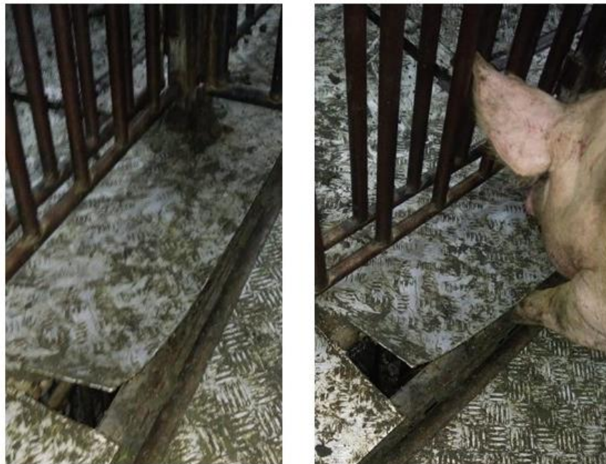
Figura 7. Fotos evidenciando buracos no piso da carroceria do caminhão, causando lesões nos animais.
