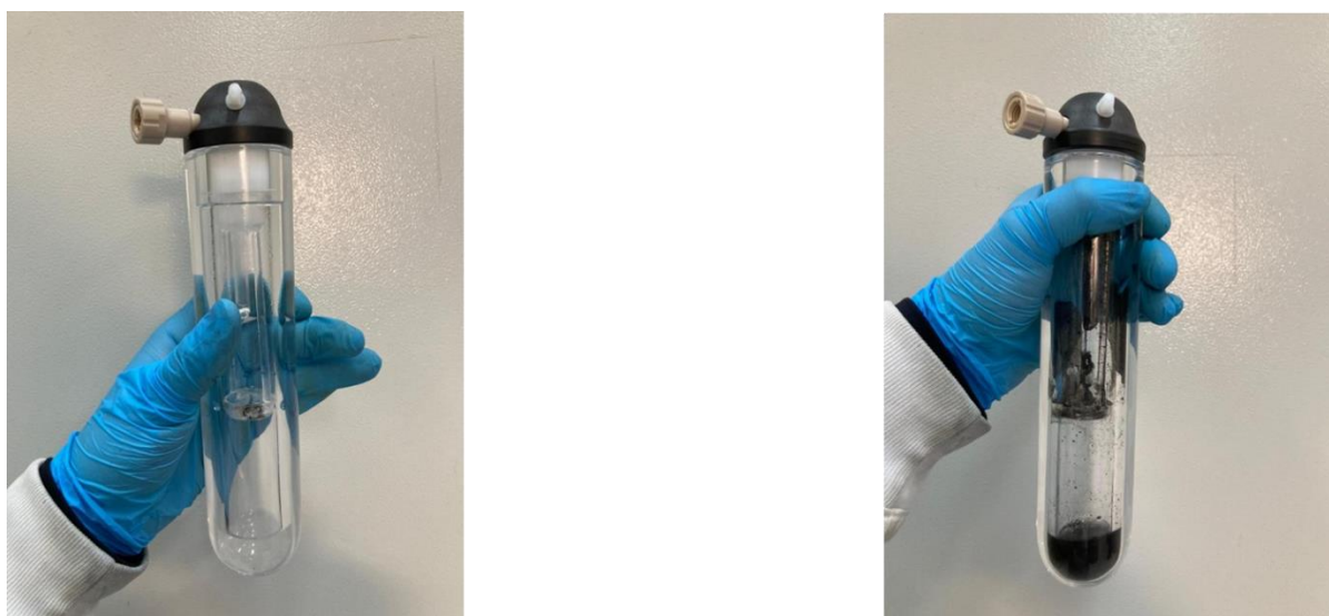
Figura 3. Frascos de quartzo após a combustão de (a) 100 a 400 mg e (b) 500 mg, de fígado animal.
