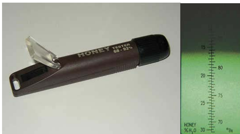
Figura 1 – Refratômetro portátil e escala de leitura (observa-se teor de 16% de umidade)
