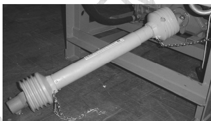
Figura 12 – Eixo cardan da TDP (A) e sua proteção externa (B).
