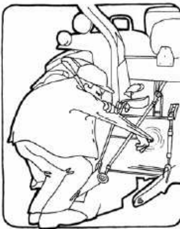
Figura 4 – Como as roupas soltas podem se prender às partes móveis do trator.
