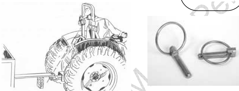
Figura 14 – Alinhamento da barra de tração ao cabeçalho do implemento e pino trava.
