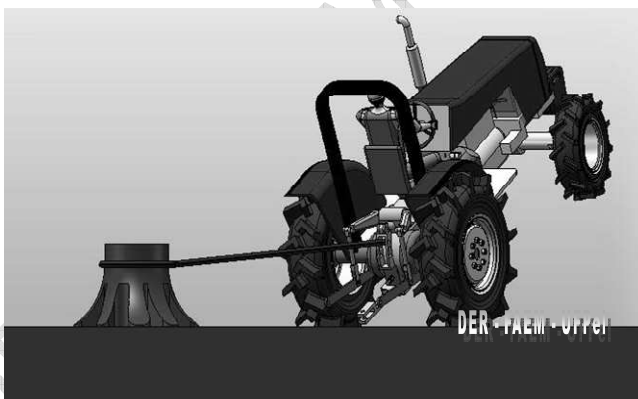
Figura 8 – Risco de capotamento pela tração de cargas pelo acoplamento do 3º ponto.
