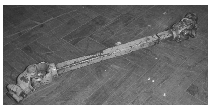
Figura 11 – Proteção principal do eixo da TDP, onde (A) é a capa do eixo.
