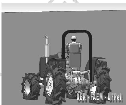
Figura 6 – Estrutura de proteção contra o capotamento do tipo arco simples.
