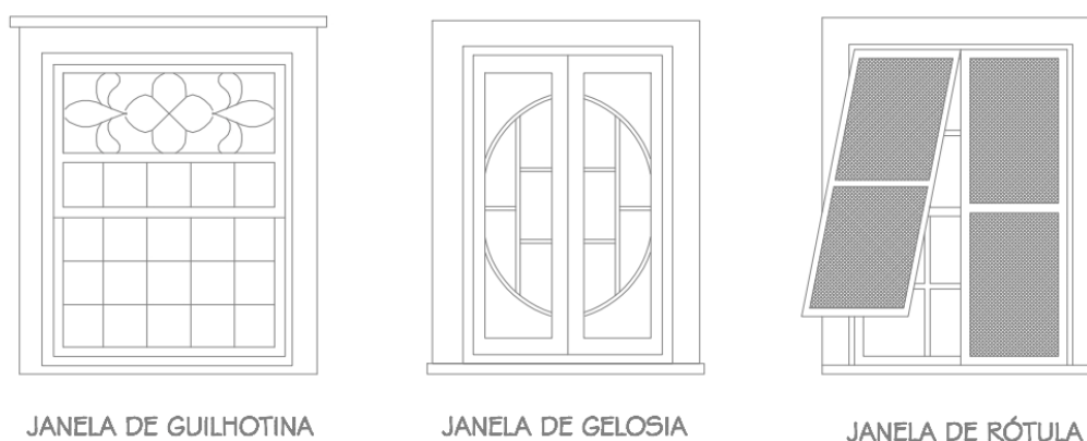
Figura 5: Tipos de janela pelo funcionamento. Fonte: Desenhos da autora, 2012.
